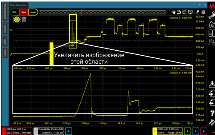
Рис. 8. Возможно регистрировать кривые быстрых переходных токов и выводить их на дисплей.
