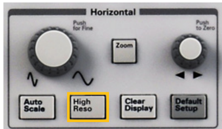
Рис. 11. Кнопка высокого разрешения для включения 16-битной разрешающей способности
