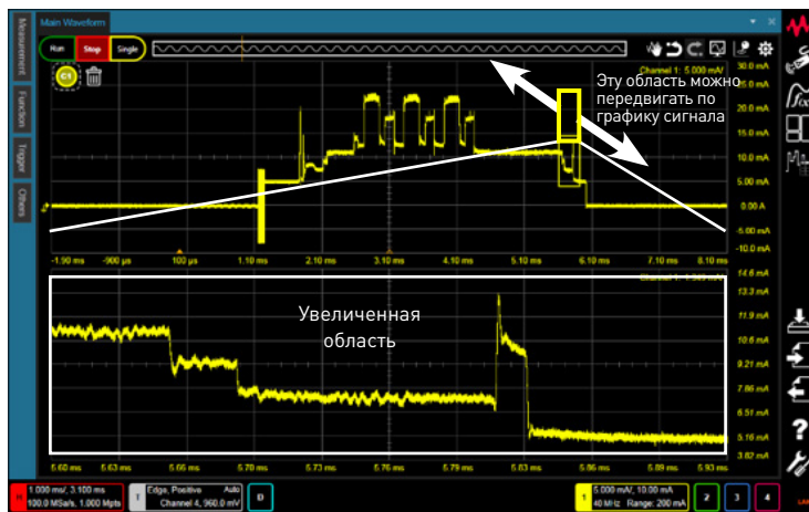
Рис. 16. Функция масштабирования «где угодно» работает подобно направленному на график формы сигнала увеличительному стеклу.
