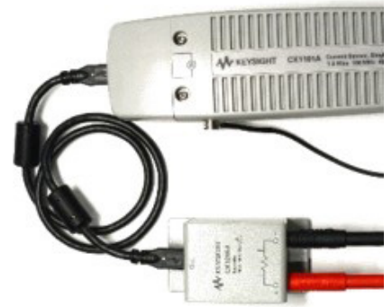
Рис. 32. CX1206A и CX1101A. Даже при работе с маломощными устройствами время от времени может потребоваться измерить ток выше 1 А. Головка датчика CX1206A с расширителем позволяет с помощью датчика тока CX1101A измерять кривые токов от 3 мА до 10 А за счет технологии шунтирующих резисторов с приведенным сопротивлением ESL (с эффективной последовательной индуктивностью).
